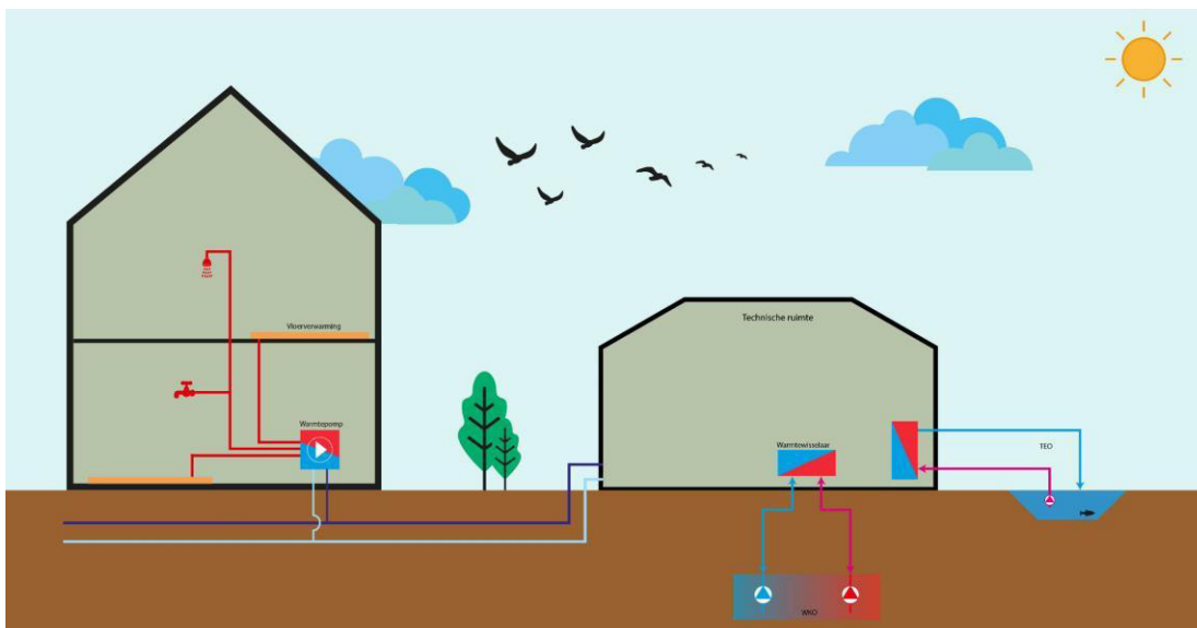
Figuur 10 Warmtenet 15°C met warmte uit de Sloterplas
